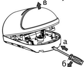
**2** Отогнуть зацеп на основании. Снять плату
