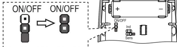
Индикатор должен замигать с частотой 1 раз в 2 с - выход извещателя в дежурный режим.
