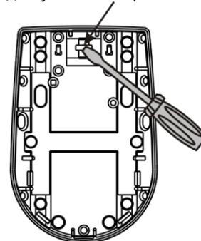
**Б)** Сделать разметку крепежных отверстий на выбранном месте по приложенному кронштейну.
