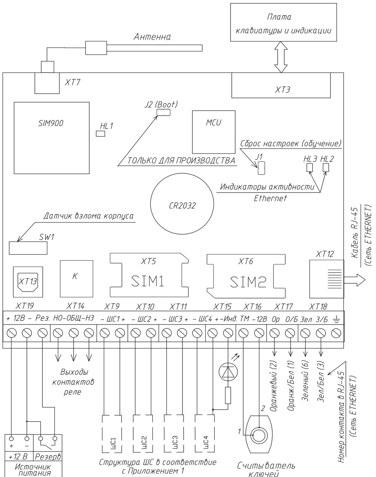
Рис 4. Подключение УОО “Юпитер 4 IP/GPRS”
