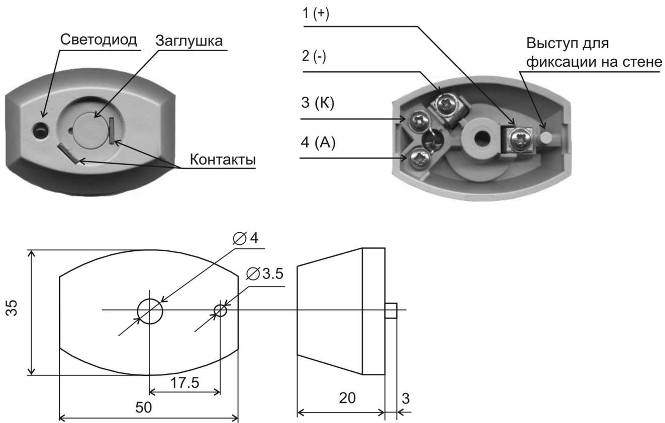
**Рис.5.6. Внешний вид, габаритные и установочные размеры прибора и считывателя ключей «Touch Memoy».**
