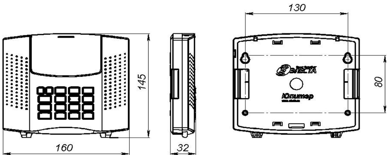
Рис 5.3. Габаритные и установочные размеры прибора
